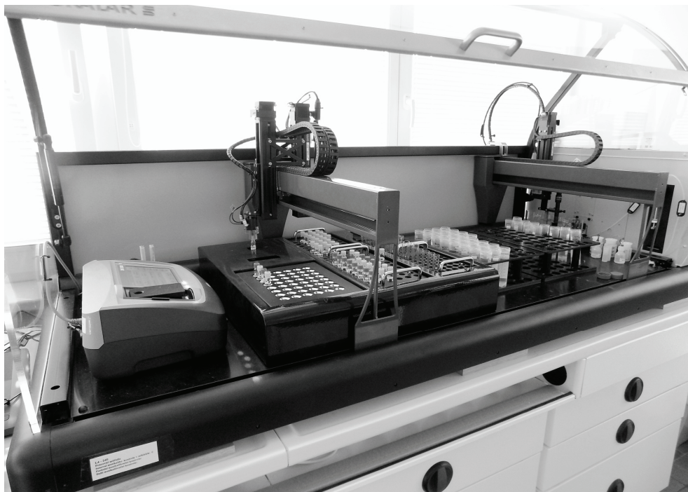
Obrázek 1: Robotický analyzátor SP2000 pro stanovení CHSKCr, pH a konduktivity. Zleva: fotometr, rameno pro stanovení CHSKCr s dilutorem a hlavou pro otevírání a zavírání zkumavek nad částí pro mineralizaci a ředění vzorku, vpravo pak rameno s elektrodami pro stanovení pH a konduktivity nad částí pro velké zkumavky pro vzorky.
