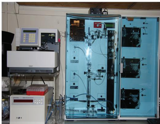
Obr.2 Izotachoforetický analyzátor EA 202A
